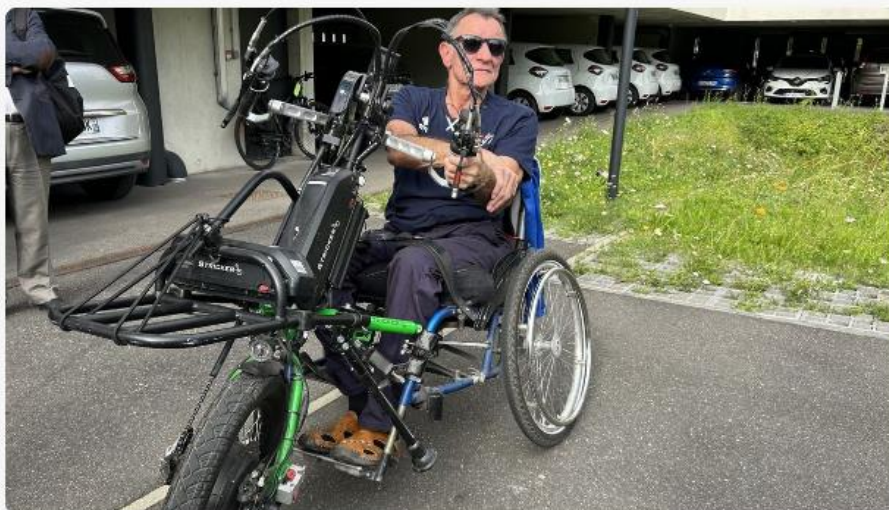
Un vélo-fauteuil qui se compose d'un fauteuil classique, avec une fourche à l'avant avec une roue, et une assistance électrique. © Radio France - Phéline Leloir-Duault
